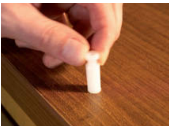
3. Plaatsen van de hettinject kleefdrevel
