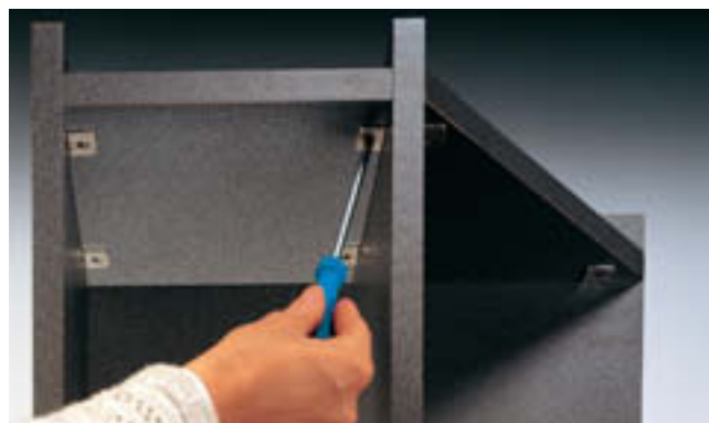
Bodemdemontage door lichte druk van een PZ2 schroevendraaierpunt. Na terugstelling van de arrêteerneus m.b.v. PZ2-kling kan de bodem opnieuw worden gemonteerd - de vergrendeling gebeurt automatisch. Indien de inlegplank niet moet worden gearrêteerd moet de arrêteerneus vooraf in openstand worden gebracht.
